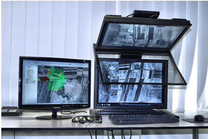
Abb. A-4-3: Arbeitsplatz zur digitalen stereoskopischen Luftbildinterpretation
